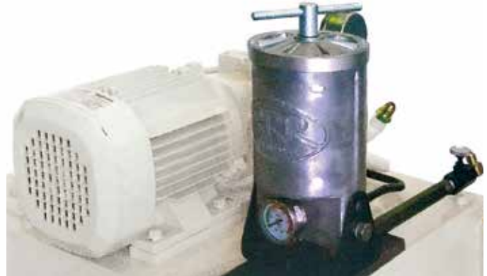
油圧オイル濾過装置
